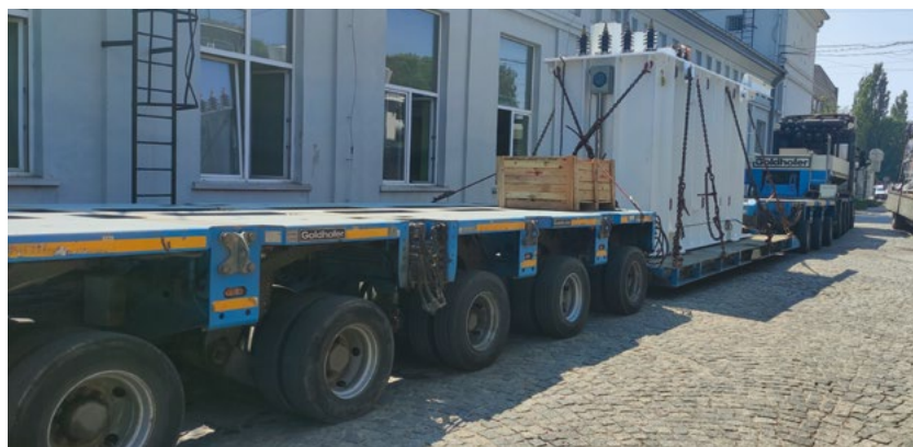
60 TONNÁS TRANSZFORMÁTOR SZÁLLÍTÁSA
