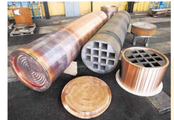
NAGY AKTIVITÁSÚ RADIOAKTÍV HULLADÉKOK KONDICIONÁLÁST KÖVETŐ TÁROLÁSÁRA SZOLGÁLÓ HERMETIKUSAN ZÁRÓDÓ KONTÉNEREK
