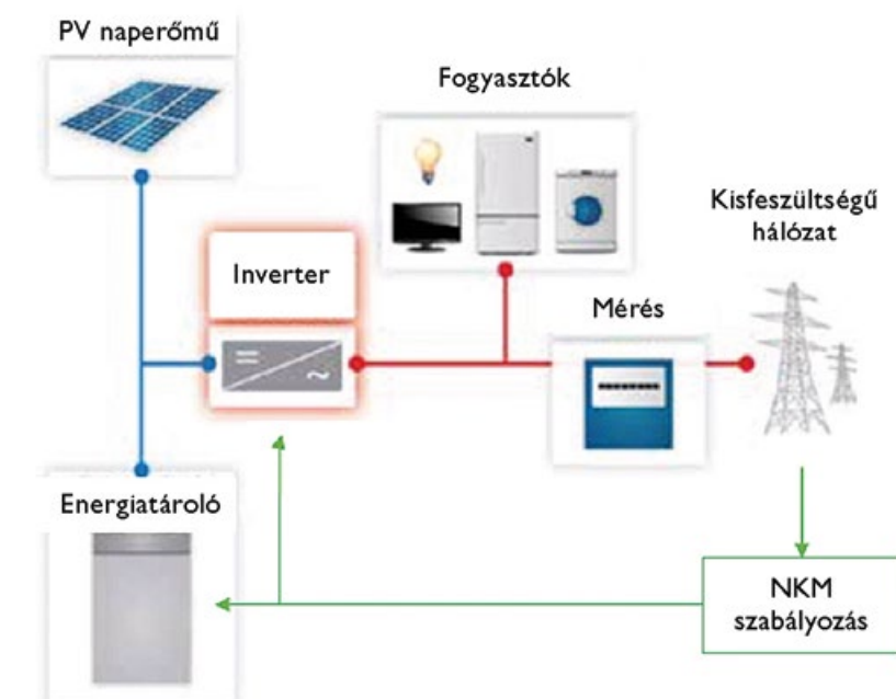
2. ÁBRA: AZ NKM ÁLTAL SZABÁLYOZHATÓ MÉRŐ MÖGÖTTI TERMELŐ-, TÁROLÓEGYSÉG VÁZLATA
